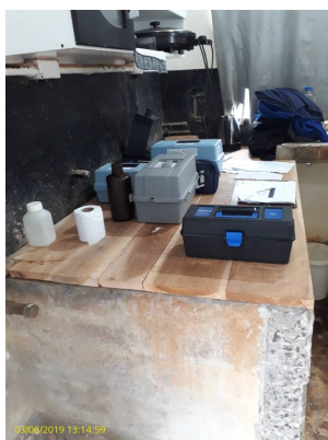
Foto 18 - Bancada para análises improvisada. Sugere-se prever local adequado conforme normas
